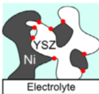
Figure I- 7 : D'après [18] –Schéma d'une anode Ni/YSZ, points triples représentés en rouge
