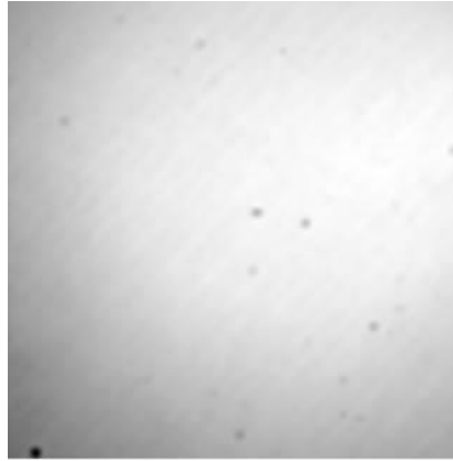
Figure 49 : Fond blanc d'imagerie de type fond clair, reconstitué en considérant pour chaque pixel le maximum d'intensité des différentes images de la série
