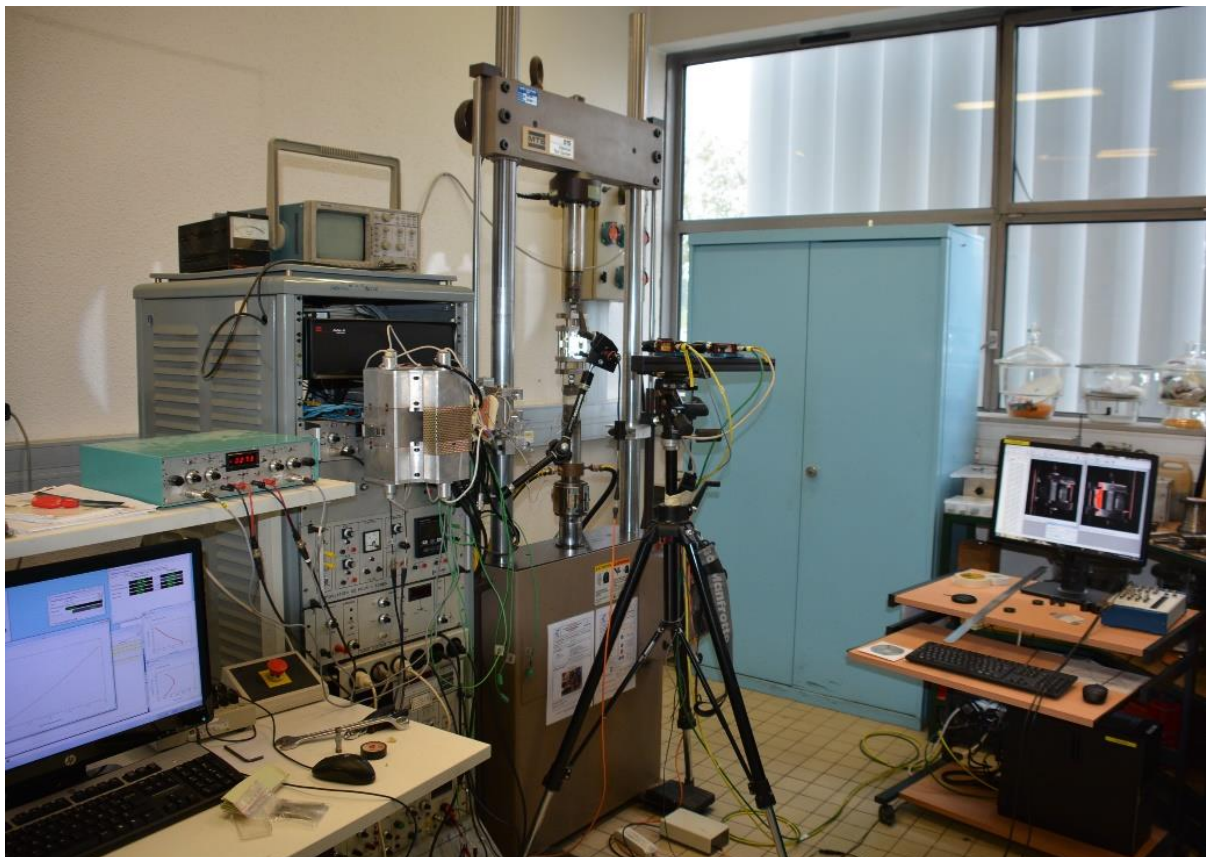
Figure 3.11 : Machine de traction et caméras de corrélation d'images utilisées pour l'essai EDC avec traction
