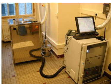
(a) Vue d'ensemble de l'installation SUNALE™ R-200, PICO-SUN™.
