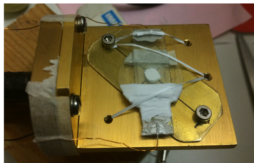
Fig. 5.13 Conception de l'échantillon pour les études sous champ électrique.
