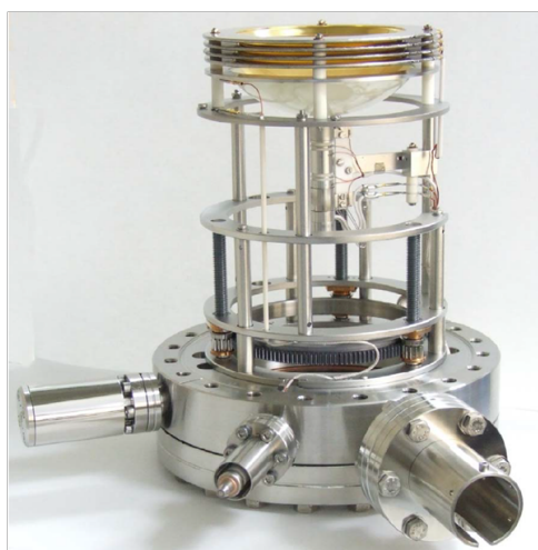
FIGURE 2.15 – Photo du SPECTALEED à 4 grilles (OMICRON) [129].
