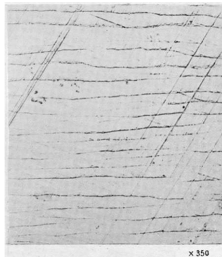
Figure I-11 : Lignes de glissement dans un monocristal de fer cubique centré [60]
