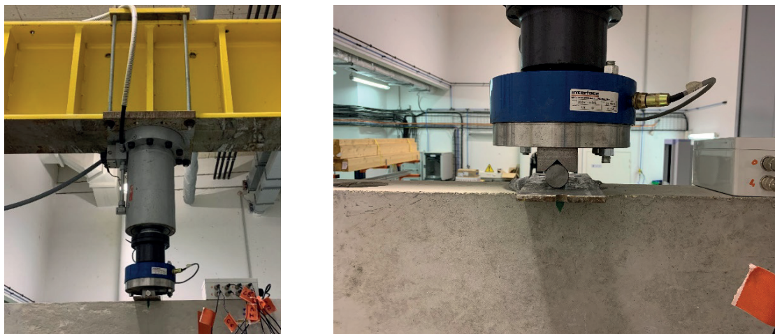
Figure IV. 20 : Détail d'appui du vérin
