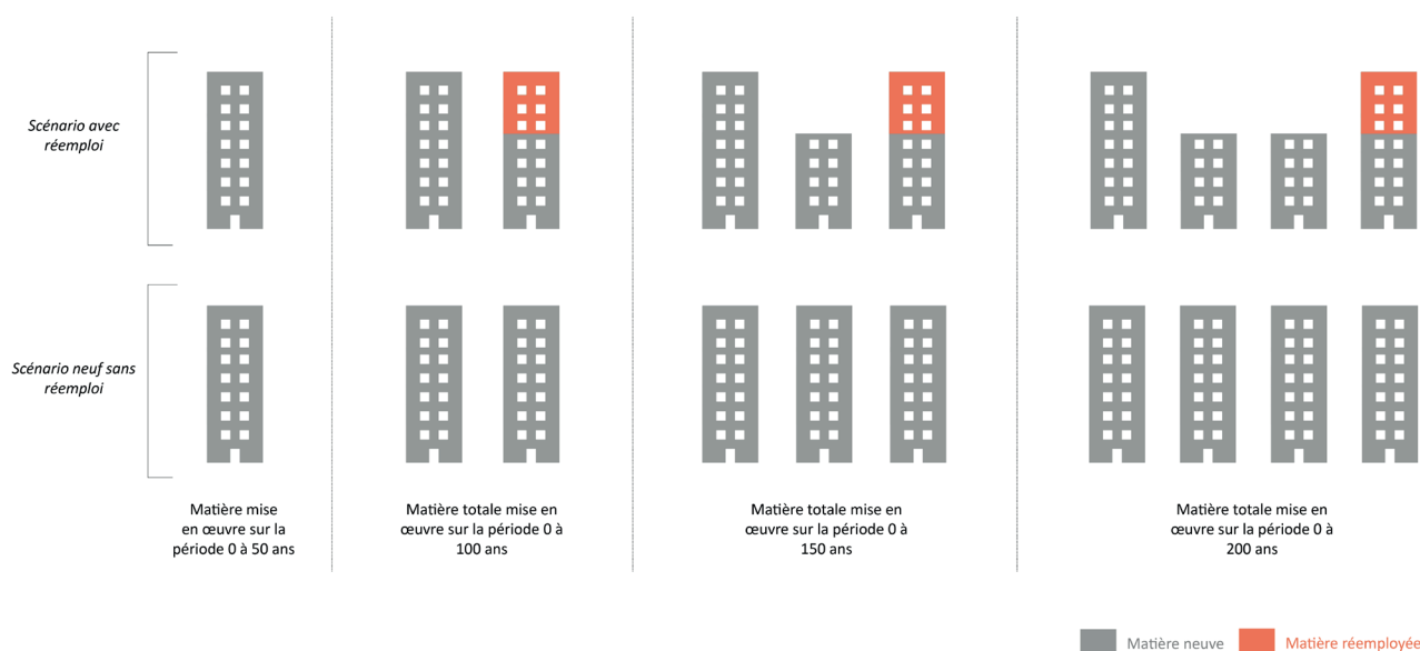
Figure II. 16 : Principe de l'étude comparative de matière mise en œuvre pour un bâtiment.
