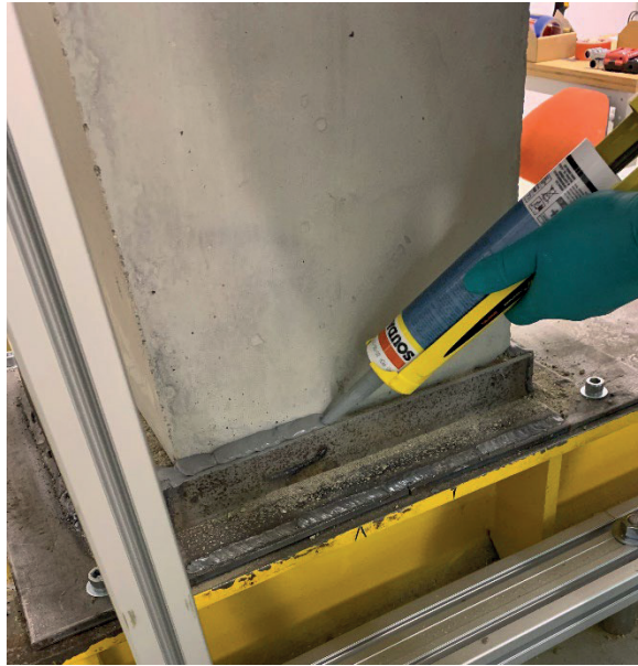
Figure IV. 16 : Confinement du sable avec du silicone, après la mise en place du portique.
