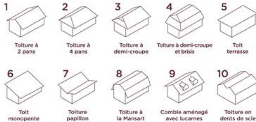
Figure 32: Types de toiture basiques (source : [10 Types de toitures])
