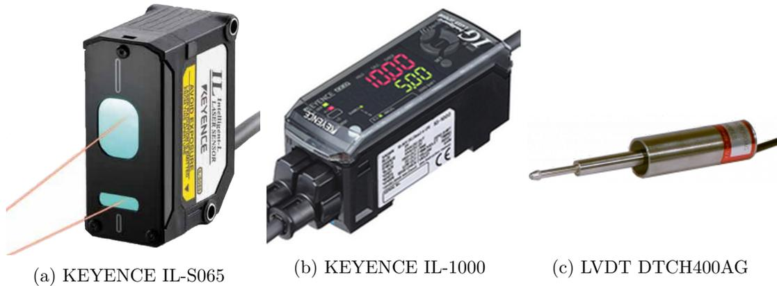
FIGURE 3.5 – Outils de mesure de déplacements
