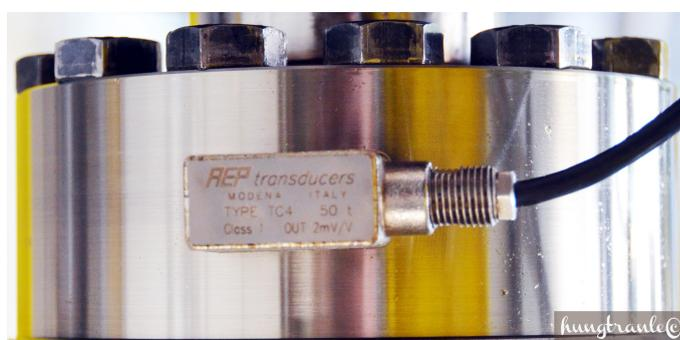
FIGURE 3.8 – Capteur de force TC4-AMP (photo source : *hungtranle*©)
