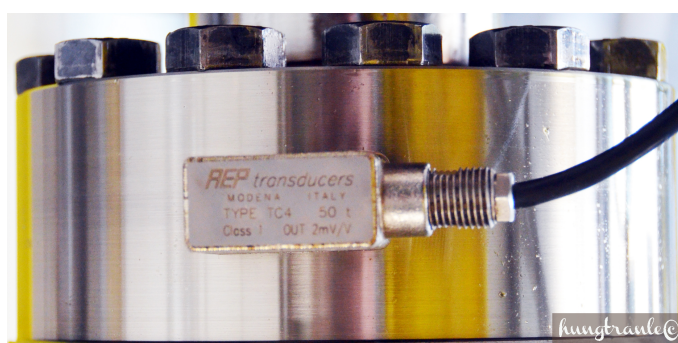
FIGURE 3.8 – Capteur de force TC4-AMP (photo source : hungtranle ©)
