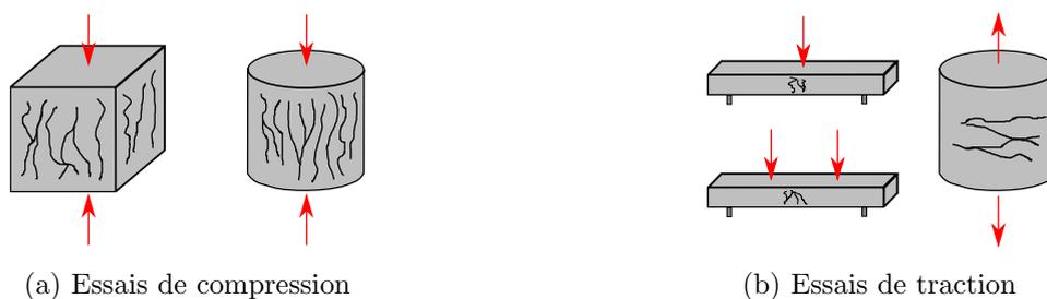
FIGURE 1.7 – Essais mécaniques du béton sous chargement statique
