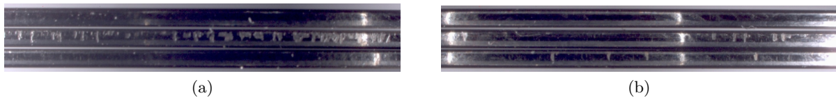
Figure 2.12 – Illustration de l'écaillage de DLC sur segments coupe-feu. Essai survitesse, DLC a-C :H [123].
