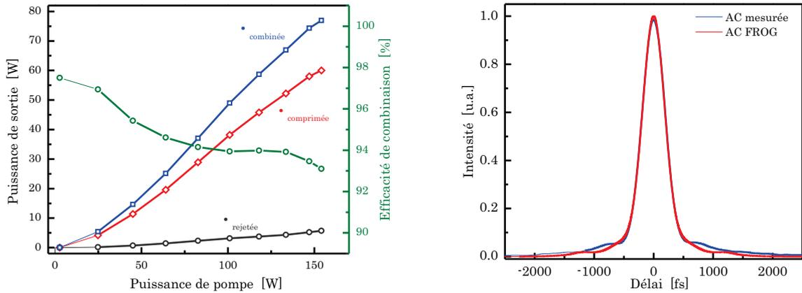
(a) Caractéristique en puissance avant et après compression et efficacité de combinaison du système à 100 kHz.
