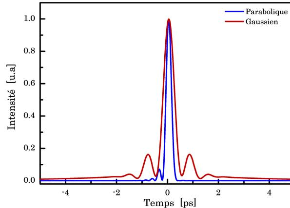
FIGURE I.12: Profils temporels comprimés, et normalisés, pour des spectres initiaux parabolique et gaussien. L'intégrale-B vaut dans les deux configurations  $8\pi$ . Dans les deux cas la durée limitée par transformée de Fourier est de 250 fs et les impulsions sont étirées à 100 ps. Le compresseur à réseaux, de 1250 traits. $\text{mm}^{-1}$  est accordé à l'étireur.
