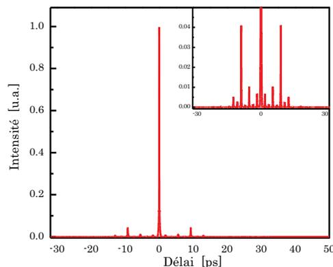
(d) Profil d'autocorrélation ( $\eta = 77\%$ ,  $\Delta\theta_{max} = 3^\circ$ ) pour 16 répliques à  $1 \mu\text{J}/\text{rép.}$ . Insert : mise en évidence des répliques parasites pour des amplitudes allant jusqu'à 5%.
