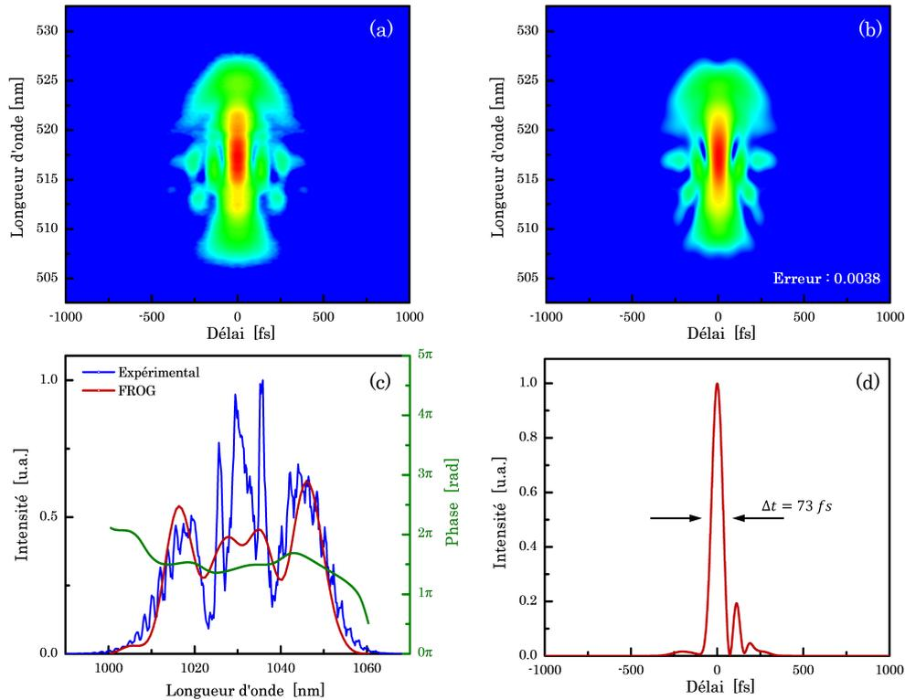
FIGURE IV.8: Traces FROG mesurée (a) et retrouvée (b) à énergie maximale. L'erreur de reconstruction est de 0.0038 sur une grille de  $512 \times 512$ . Spectre mesuré indépendamment et retrouvé (c), la phase spectrale est également tracée. Pour plus de clarté, le spectre retrouvé est normalisé par rapport aux modulations du spectre expérimental. Profil temporel retrouvé (d).
