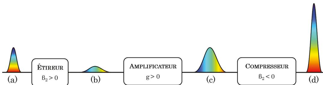
FIGURE I.5: Principe de l'amplification à dérive de fréquence. Une impulsion courte de faible énergie (a) est étirée temporellement (b) puis amplifiée (c). Un compresseur introduit la dispersion opposée à celle de l'étireur pour générer une impulsion à la fois courte et de haute énergie (d). D'après [Morin 10].
