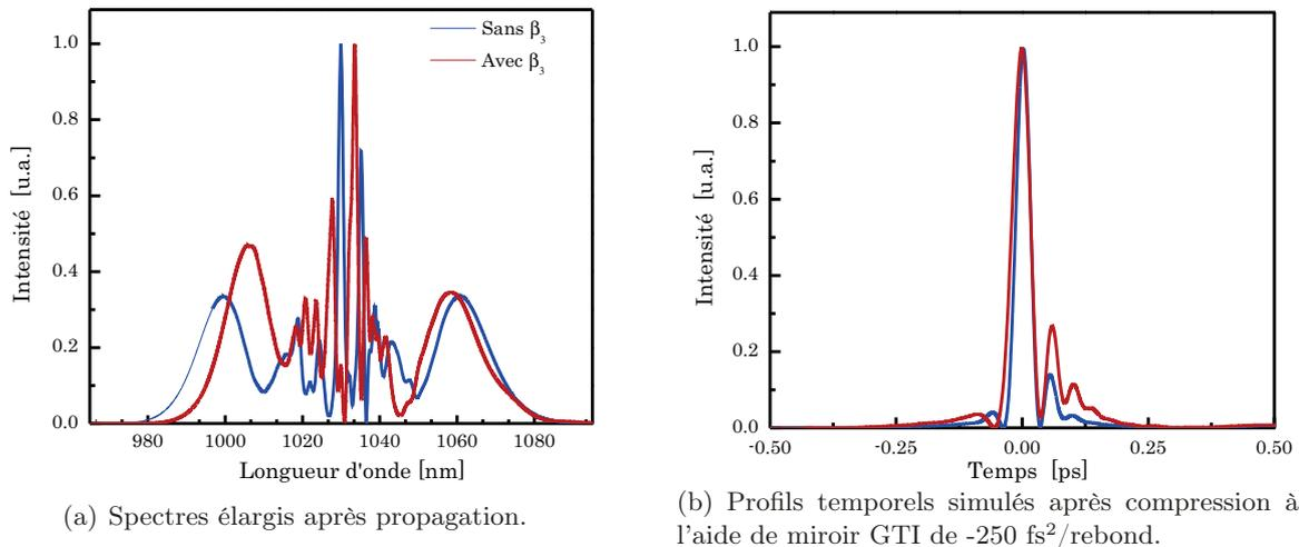
FIGURE IV.15: Impact du troisième ordre de dispersion sur l'élargissement spectral et la qualité temporelle. La propagation est simulée dans une fibre ayant un  $MFD = 40 \mu\text{m}$ , une longueur de 1,2 m et les mêmes propriétés dispersives exposées sur la figure IV.14. L'indice non-linéaire de l'air est pris ici  $n_2 = 3,2 \times 10^{-23} \text{ m}^2 \cdot \text{W}^{-1}$ .
