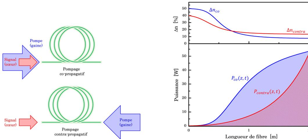
(a) Architecture de pompage co- et contra-propagative. Dans une fibre double-gaine, la pompe est injectée dans une gaine multimode, à large ouverture numérique, permettant le pompage avec des diodes de puissance.
