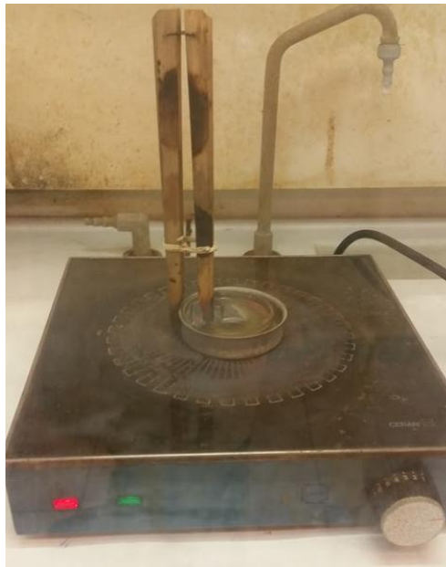
Figure 176 : Attaque chimique sur un morceau de roue polaire
