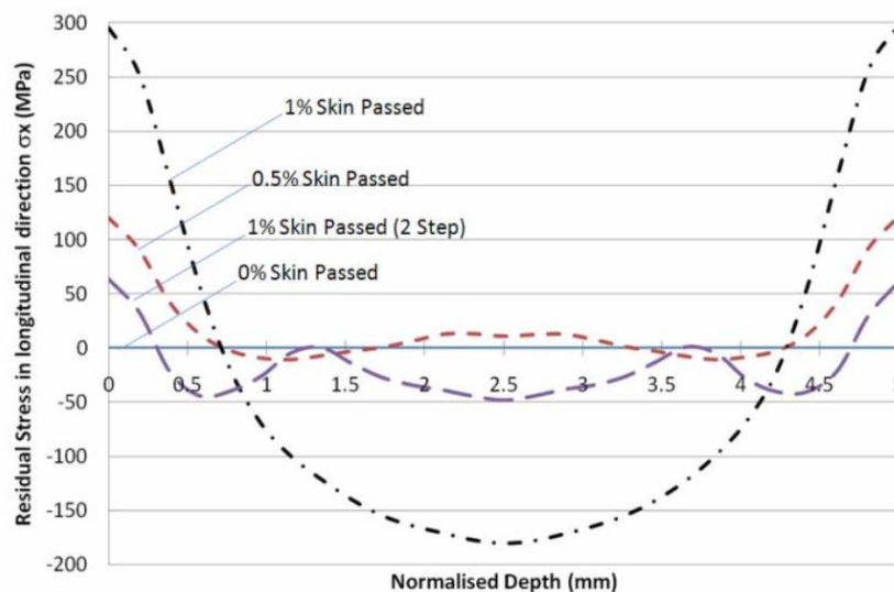
Figure 34 : Effet du taux de déformation sur le profil de contraintes résiduelles en laminage à froid (skin-pass) (Weiss et al., 2010)
