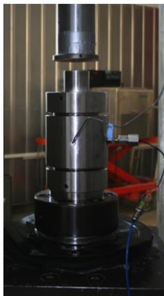
FIGURE A.4. Photo de la presse MTS1 avec cellule fermée.
