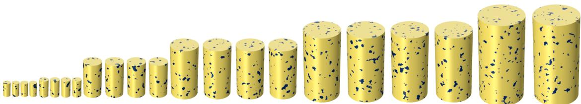
FIGURE 1.28. Carottage numérique d'éprouvettes d'élanement 2 du bloc de la Figure 1.27. De gauche à droite, quatre éprouvettes sont carottées avec un diamètre de  $4a$ ,  $5a$ ,  $10a$ ,  $15a$ ,  $20a$  et  $25a$ , avec  $a$  la taille caractéristique des insolubles.
