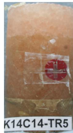
FIGURE A.5. Jauges collées sur une éprouvette de sel.
