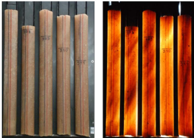
FIGURE A.3. Sel des Landes : vue de quelques carottes reçues (gauche) et aperçu qualitatif de la teneur en insolubles (droite).
