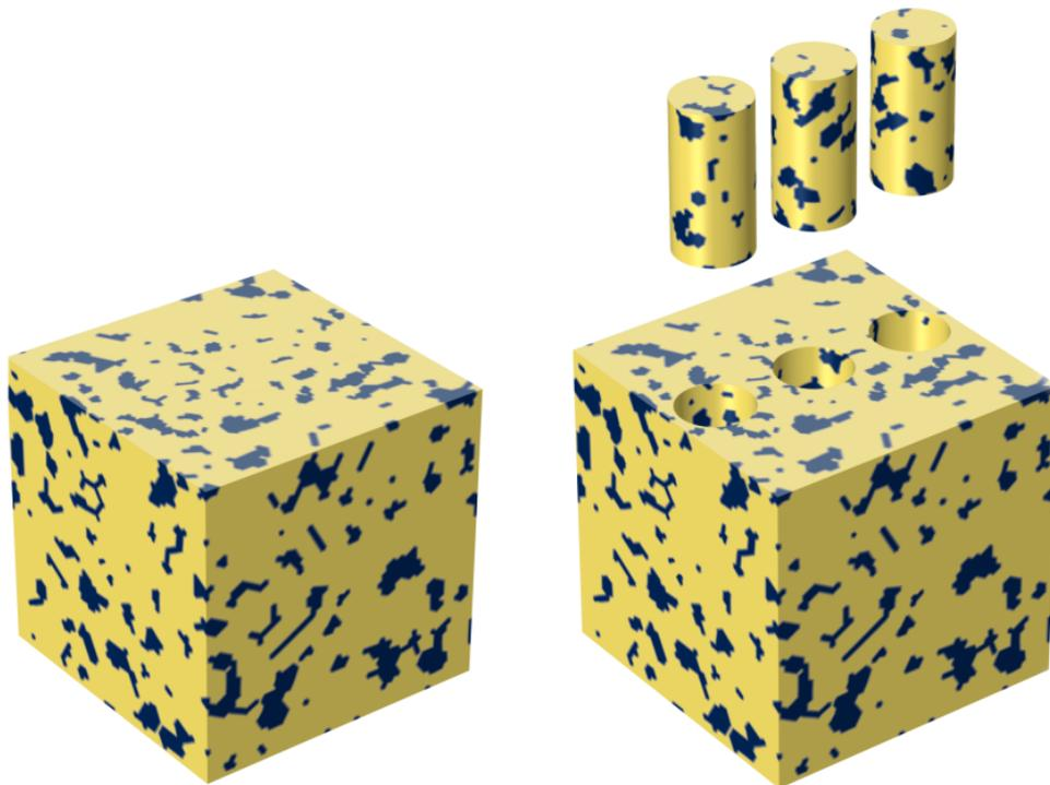
FIGURE 1.15. Matrice cubique avec des inclusions distribuées suivant un seuillage d'un champ aléatoire Gaussien et trois éprouvettes cylindriques qui y sont numériquement prélevées.
