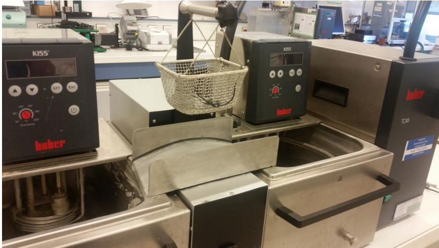
Figure 4.5 : Photographie du dispositif de thermocyclage. Les fonctions chauffantes sont réalisées par les deux boîtiers au-dessus des cuves et le refroidissement par le cryoplongeur à droite de l'image. Le bras mécanique au centre permet le passage du panier d'une cuve à l'autre
