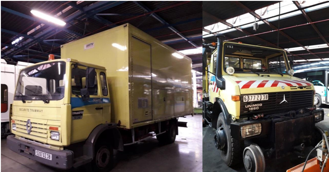
Figure 15 : Un véhicule ré-enrailleur, Renault RVI (à gauche) ; un véhicule rail-route, Mercedes Unimog (à droite).
