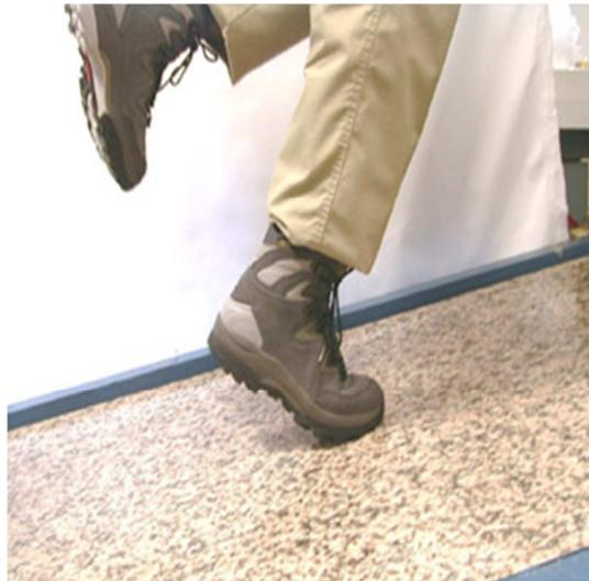
**Figure II.1:** Test de caractérisation du « grip » en montée sur le plan incliné mouillé.
