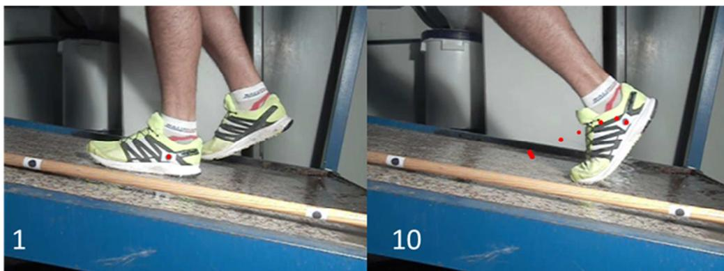
**Figure III.20** : Déplacement du repère de la chaussure lors du glissement.
