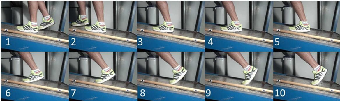
**Figure III.19** : Glissade lors de la propulsion en montée. Temps variable entre les clichés : 1-3 : 0,5 s ; 3-5 : 0,2 s ; 5-10 : 0,025 s pour un temps total de 1,525 s.
