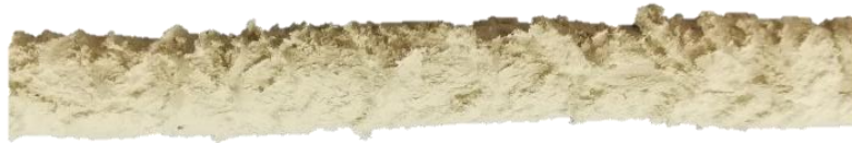
Figure 55 Délaminations en sortie d'extrudeuse sur la formulation contenant 4% m,c de liant Optapix S51, 2% m,c de plastifiant Zusoplast C92 et 1% m,c de dispersant Glenium 51
