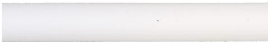
Figure 58 Tronçon d'extrudat sec obtenu à une vitesse de sortie de 9 \text{ mm.s}^{-1} correspondant à une poussée à 1 \text{ mm.s}^{-1} , 10 mm de diamètre et 80 mm de longueur
