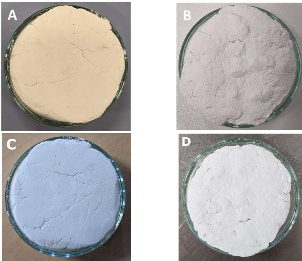
Figure 60 A : Pâte de référence avant séchage C : Pâte de référence après séchage B : Pâte de référence sans lubrifiant avant séchage D : pâte de référence sans lubrifiant après séchage
