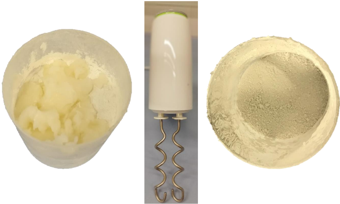
Figure 29 A gauche, phase « liquide » en jaune crème reposant sur le mélange de céramiques, au milieu, le mélangeur Braun HandMixer 5000WH équipé des pales hélicoïdales, à droite, la poudre précurseur de la pâte
