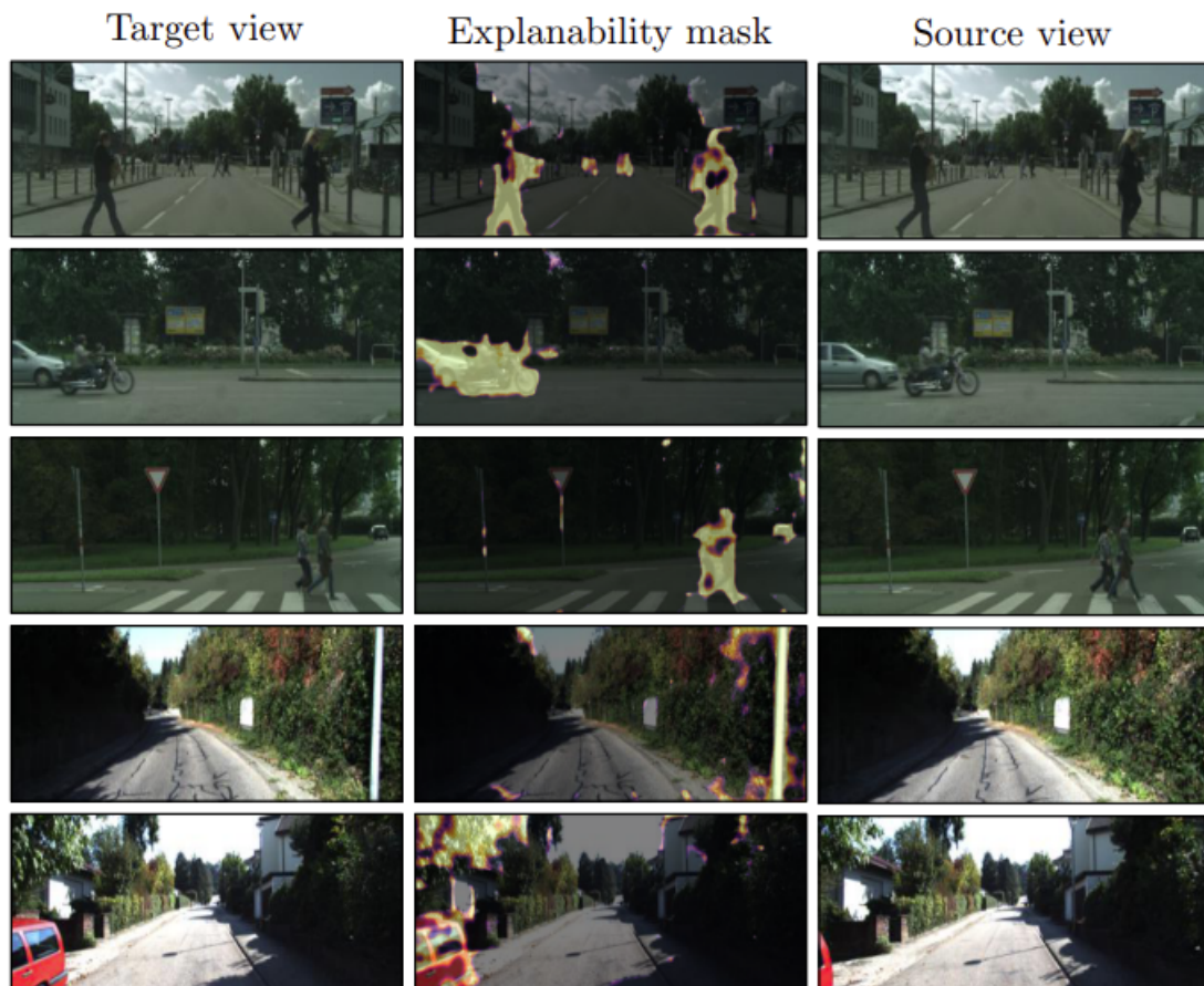
FIGURE 7.5 – Exemple de masques d’explicabilité calculés par le réseau de Zhou et al. [2017]. L’idée est d’estimer les pixels de l’image source qui ne respectent pas les hypothèses nécessaires à la fonction de coût de reprojection, i.e. une scène statique sans objets dynamiques ainsi que l’absence d’occultation entre les deux vues source et cible. On constate que le réseau arrive bien à estimer quelles parties de l’image représentent des objets dynamiques (3 premières lignes) ou bien les parties de l’image source susceptibles d’apporter des occultations dans l’image cible comme la présence de végétation (2 dernières lignes). Image provenant de Zhou et al. [2017].
