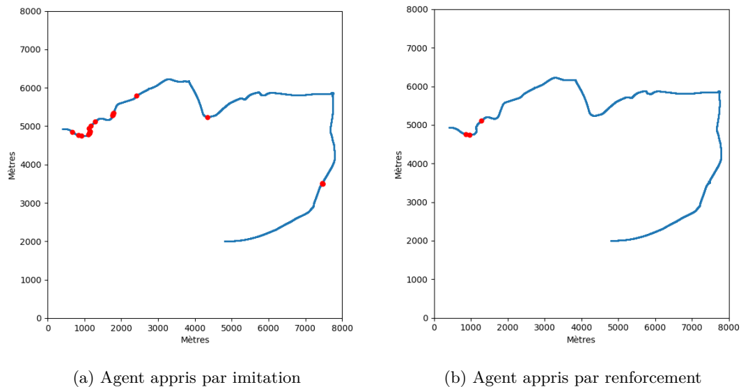
FIGURE 7.12 – Comparaison du nombre de reprises en main (les points rouges) entre notre agent appris par imitation (à gauche, 20 reprises en main) et notre agent appris par renforcement (à droite, 3 reprises en main). Les deux agents ont été évalués sur le même trajet d’environ 15km.
