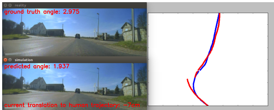
FIGURE 6.16 – Capture d'écran de notre simulateur, la trajectoire bleue est celle du conducteur humain, en rouge la trajectoire du véhicule conduit par le réseau de neurones. A l'instant capturé, le réseau est décalé de 7cm à droite par rapport à la trajectoire originelle. On peut voir sur la trajectoire rouge que le réseau n'a pas réussi à prendre le virage précédent, il est sorti de sa voie. Une reprise en main a donc été effectuée, i.e. nous avons remis le réseau à la position de la trajectoire du conducteur humain.
