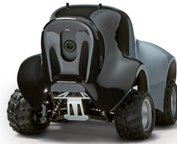
FIGURE 3.3 – La voiture robotique de AWS DeepRacer. L'idée est de fournir une interface pour d'abord entraîner les agents en simulation pour les faire ensuite concourir dans des compétitions réelles entre les différents participants.
