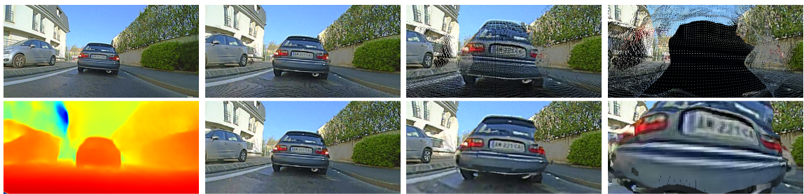
(a) Image initiale et profondeur estimée (b) Zoom simulé de 1m (c) Zoom simulé de 2m (d) Zoom simulé de 3m
