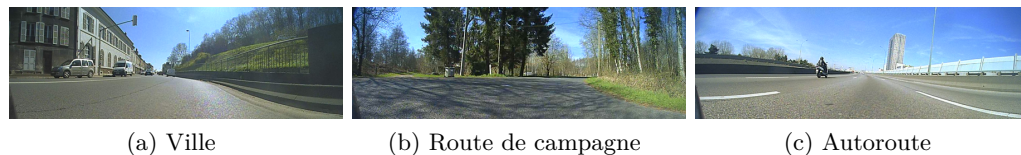
FIGURE 6.12 – Projection cylindrique de l'image fisheye provenant de la caméra frontale dans des lieux représentatifs de notre base de données.
