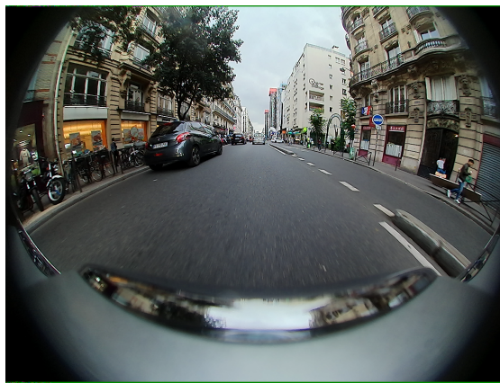
FIGURE 6.11 – Exemple d'image fisheye haute résolution ( 1280 \times 800 ). On peut distinguer des distorsions de l'image en particulier sur les cotés de l'image.
