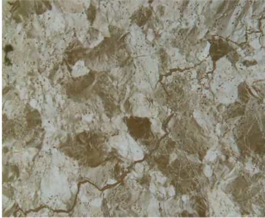
FIGURE 1.15 – Micrographie d'une zone d'un échantillon rompu en compression simple quasi-statique à température ambiante, contenant une fissure non débouchante.
