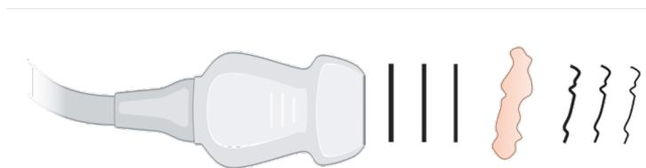
FIGURE 1.16 – Représentation de l'effet d'une aberration sur un front d'onde plan en transmission.
