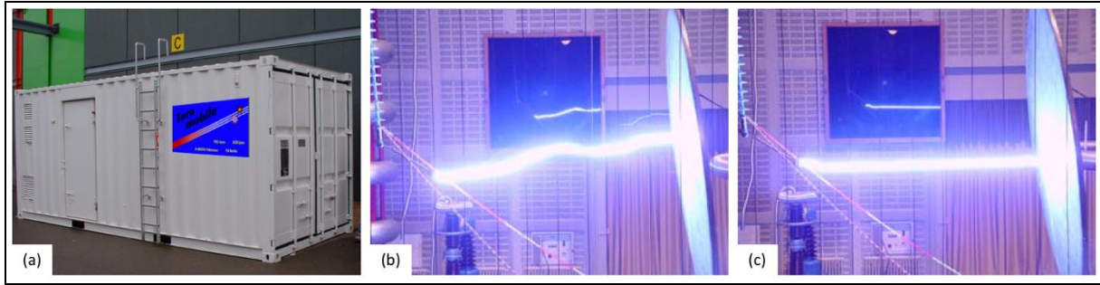
Figure 22. Exemple de laser téramobile. (a) : laboratoire mobile. (b) : rayonnement à haute intensité entre deux électrodes sans guidage par laser téramobile. (c) : rayonnement à haute intensité entre deux électrodes avec guidage par laser téramobile.
