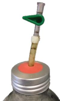
Figure 16 : Dispositif de prélèvement des supports mis en place sur les digesteurs batchs
