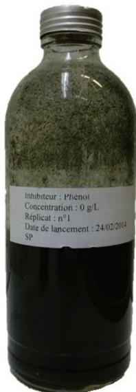
Figure 15 : Digesteur batch
