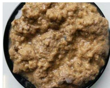
Figure 14 : Biodéchet issu du biodéconditionneur industriel
