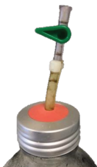
Figure 16 : Dispositif de prélèvement des supports mis en place sur les digesteurs batchs
