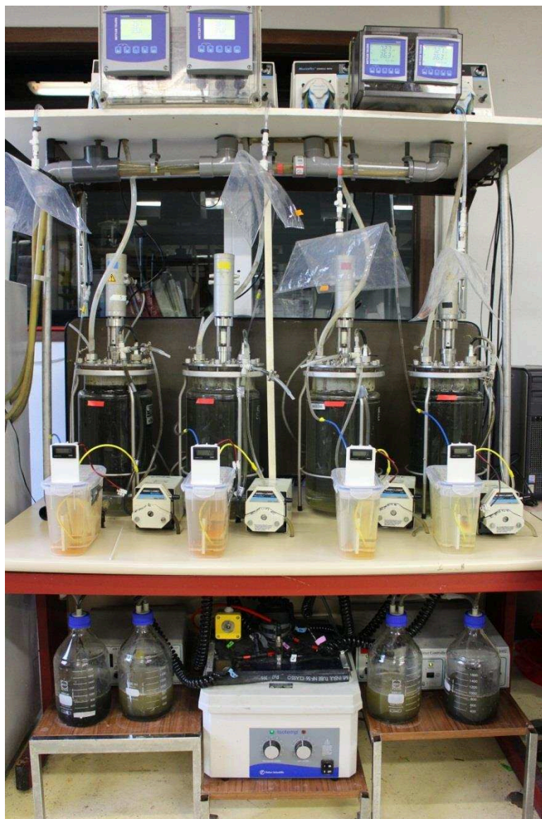
Figure 18 : Dispositif expérimental composé des quatre digesteurs semi-continus automatisés
