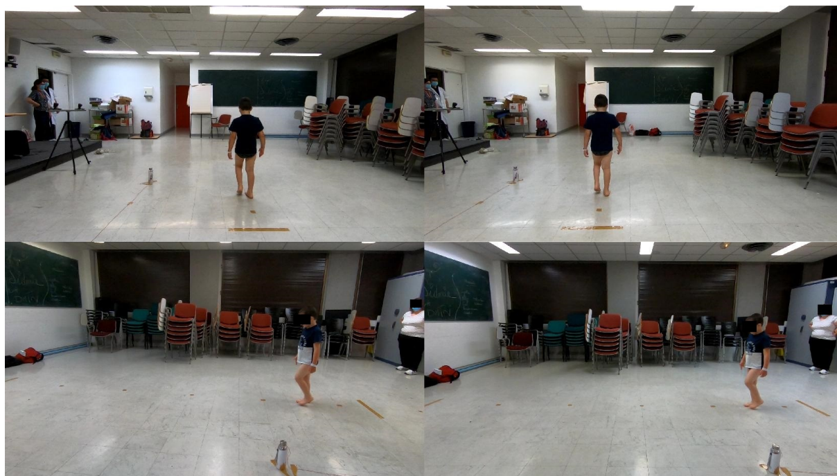
FIGURE 13: Session d'AQM menée à l'hôpital du Kremlin-Bicêtre à l'aide du système de capture du mouvement sans marqueurs. Quatre images sont capturées par les quatre caméras RGB du système sans marqueurs.
