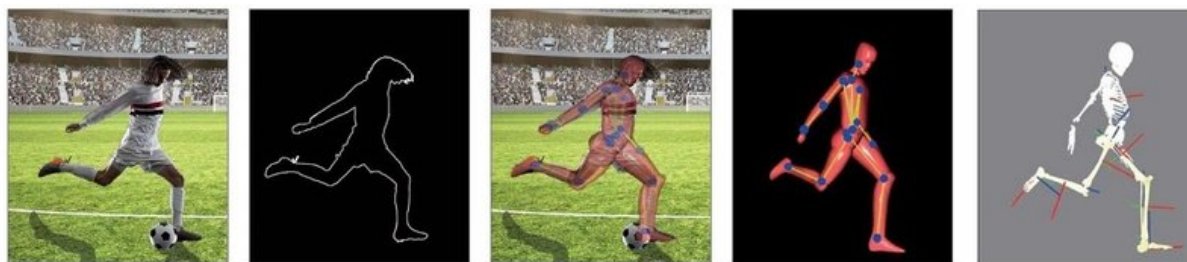
FIGURE 5: Travail avec le système de capture du mouvement sans marqueurs du SIMI Motion. De gauche à droite : enregistrement, extraction de la silhouette, ajustement du modèle 3D du corps humain et calcul des positions et des angles des articulations en 3D. Reproduit à partir de SIMI Motion.
