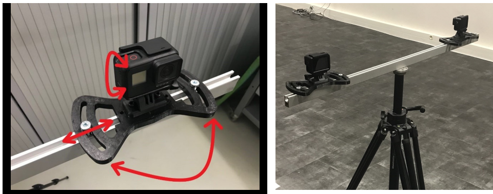
FIGURE 8: gauche : la caméra GoPro Hero 7 Black est montée sur la barre d'aluminium à l'aide d'une fixation imprimée en 3D. La position et l'orientation de la caméra peuvent être ajustées par les trois degrés de liberté. droite : deux caméras sont montées sur la barre d'aluminium, qui est installée sur un trépied.
