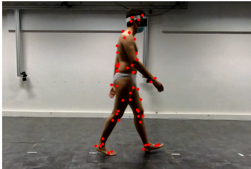
FIGURE 12: Projection de marqueurs (capturés par le système basé sur les marqueurs) sur le plan image d'une caméra latérale du système de capture du mouvement sans marqueurs pour assurer la qualité de la synchronisation.
