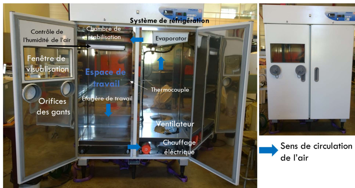
Figure 20. Schéma de la « boîte-à-gants » pour les observations microscopiques à température et humidités contrôlées
