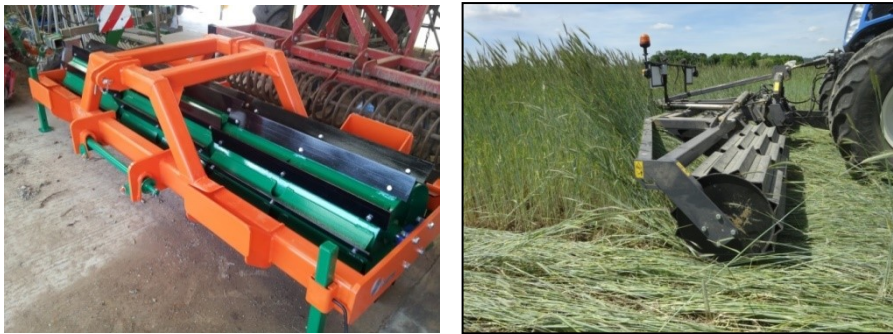
Figure 41: A gauche, le rouleau co-construit pour les essais (3 m de large, 1.4 T). A droite, le rouleau FACA (R) (6 m de large, 2T sans eau).
