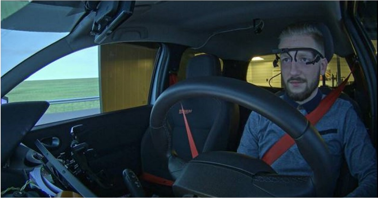
FIGURE 6.11 – Participant avec les lunettes de mesure pendant la simulation
