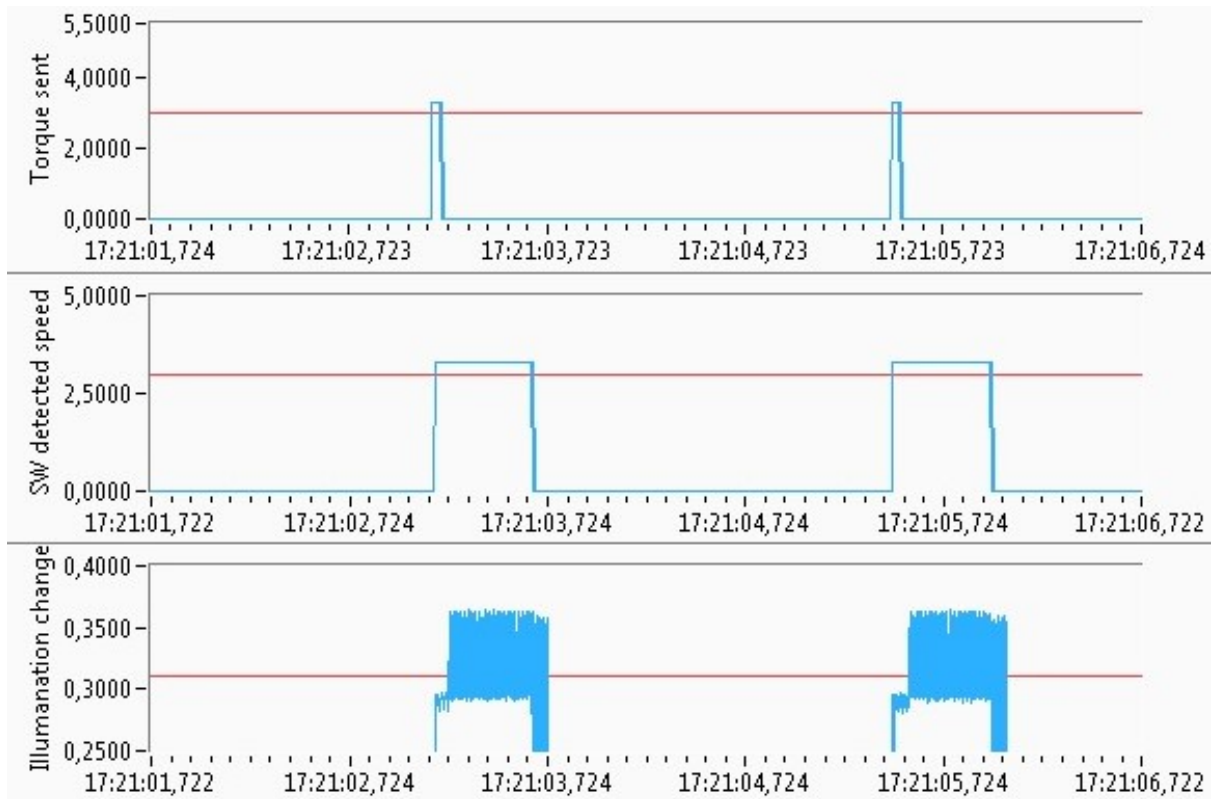
FIGURE 5.5 – Mesure de la latence visuelle d’Ultimate
