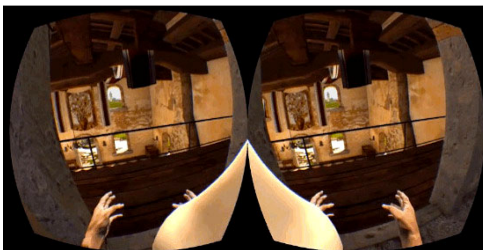
FIGURE 3.12 – Exemple de la vue du nez virtuel dans le casque [WHITTINGHILL et al. 2015]
