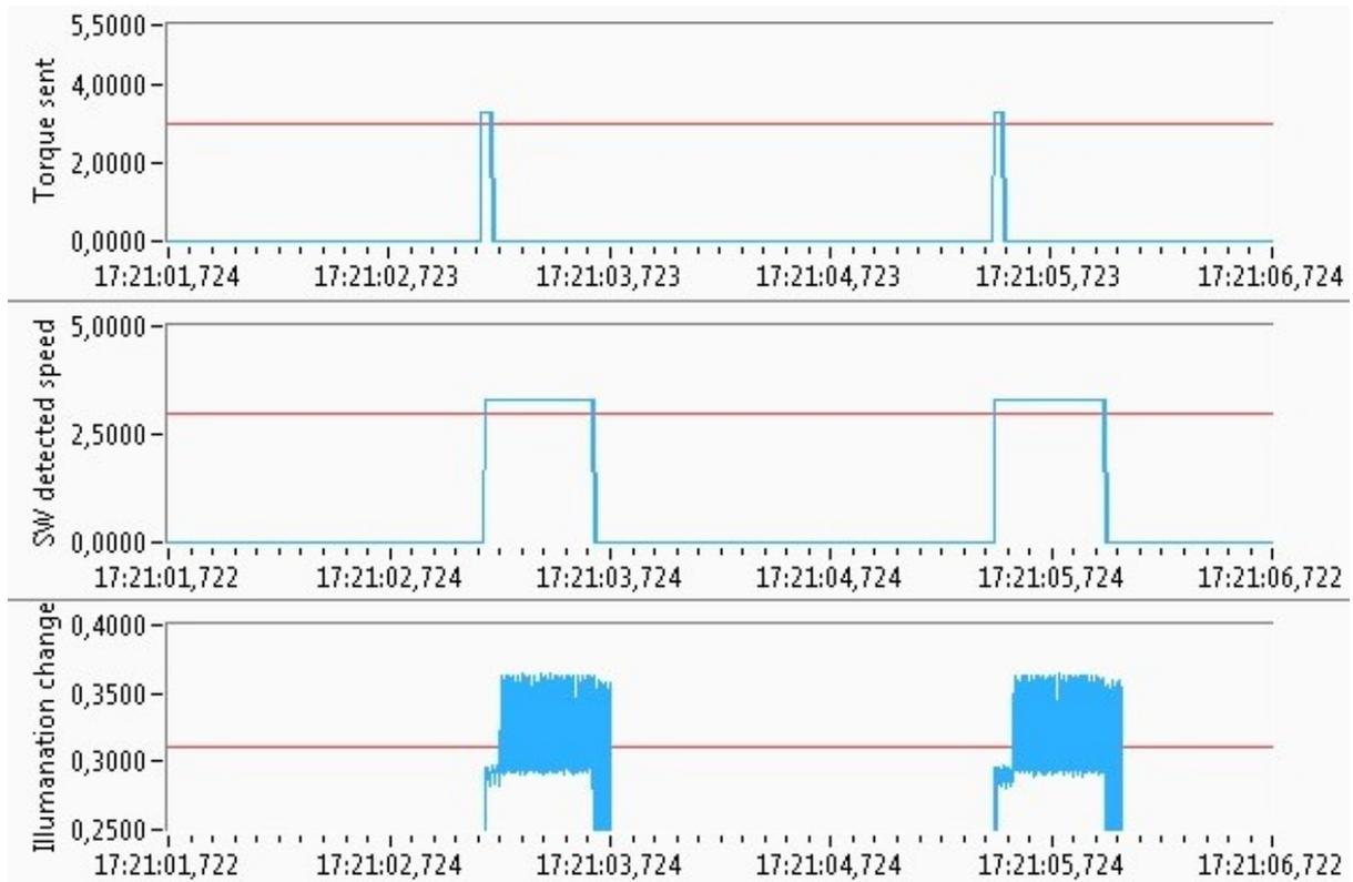
FIGURE 5.5 – Mesure de la latence visuelle d’Ultimate
