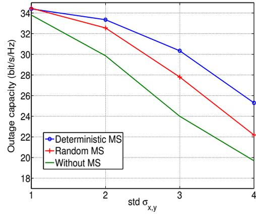
**Figure E.12:** Capacités de coupures en fonction du std pour la fibre 10-mode pour différentes stratégies de brouillage et un SNR = 20 dB
