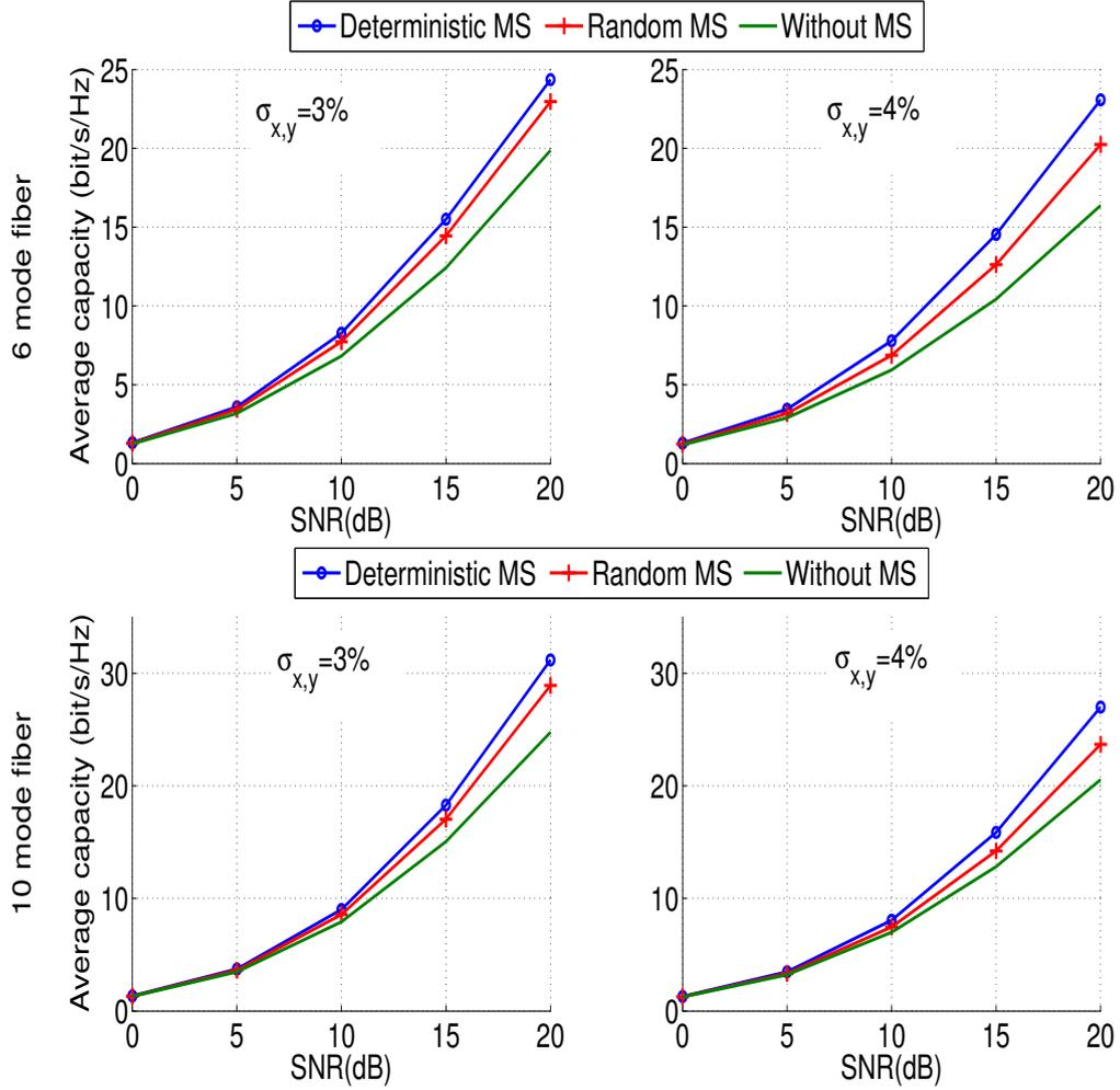
**Figure E.10:** Capacités moyennes pour les fibres 6- et 10-mode pour différentes stratégies de brouillages et un std  $\sigma_{x,y} = 3\%$ ,  $4\%$ .
