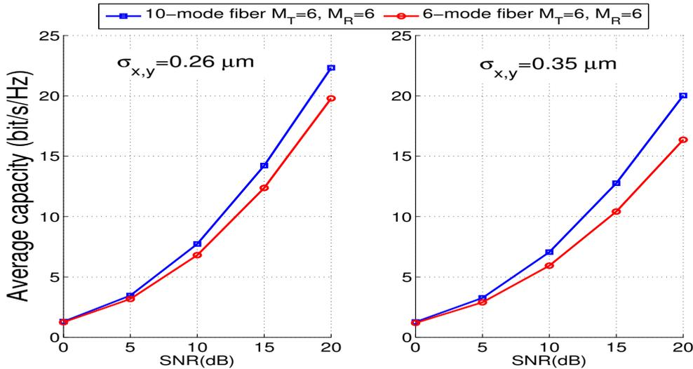
Figure E.15: Capacités moyennes pour la fibre 6-mode et la fibre 10-mode utilisant  $M_T = M_R = 6$  modes à l'émission et la réception.
