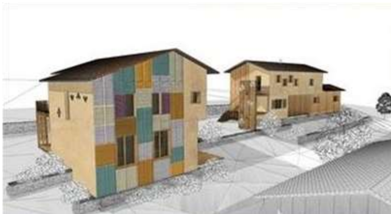
Façade en volets recyclés de la salle d'activités (à gauche)
