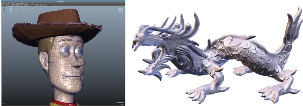
FIGURE 1.2 – A gauche, Maillage réalisé manuellement par un artiste (*Toy Story*, Pixar). A droite, Modèle reconstruit à partir d’une sculpture de dragon scannée (*Stanford 3D Scanning Repository*).
