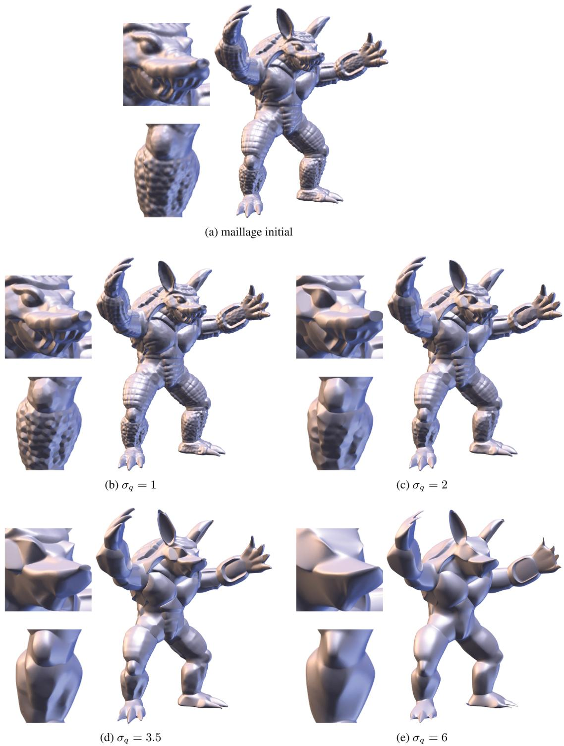
FIGURE 4.3 – Filtrage simple basé QEM, pour plusieurs valeurs de  $\sigma_q$ .  $\sigma_q$  est exprimé en fonction de la longueur moyenne des arêtes du maillage. On observe l’accentuation des arêtes vives à l’échelle de  $\sigma_q$ , même pour des niveaux de lissage très élevés. Les structures plus petites disparaissent.
