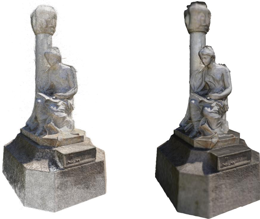
FIGURE 1.4 – Nuage de points brut d’une statue numérisée (photogrammétrie), et résultat maillé après reconstruction et traitements.
