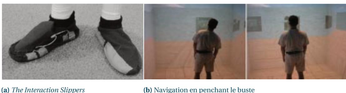
**FIGURE 3.26** – À gauche, *The Interaction Slippers* permet de faire apparaître ou disparaître le WIM et de se déplacer au sein de celui-ci. À droite, l'utilisateur se penche pour naviguer dans la scène.
