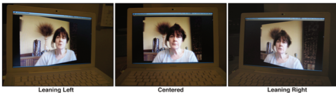
FIGURE 3.22 – La perspective couplée à la tête est utilisée par Harrison et Hudson [2008] afin d’augmenter la présence dans le contexte de la vidéoconférence en adaptant la perspective par rapport à la position de la tête.
