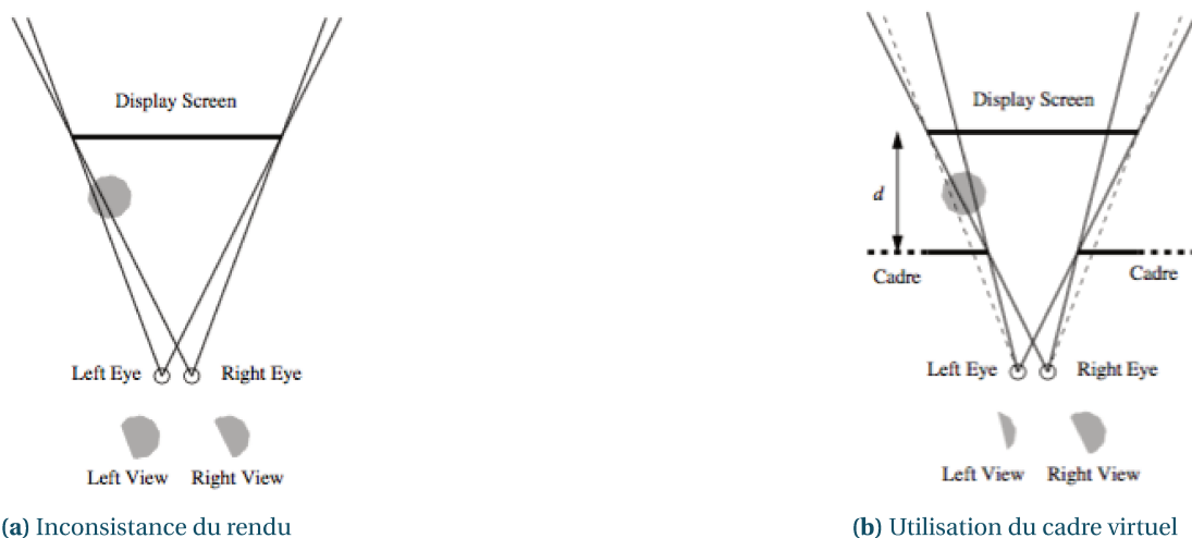
FIGURE 3.21 – Sur les deux figures, un objet 3D est situé à une profondeur plus faible que le centre de la rotation de la perspective couplée à la tête (parallaxe négative). L'objet paraît donc sortir de l'écran. À gauche, l'objet paraît tronqué du fait de la limite de l'écran, ce qui rend le rendu inconsistant. À droite, en ajoutant un cadre virtuel entre la projection de l'objet et les yeux de l'utilisateur, l'objet paraît tronqué par le cadre virtuel et non plus par les limites de l'écran.
