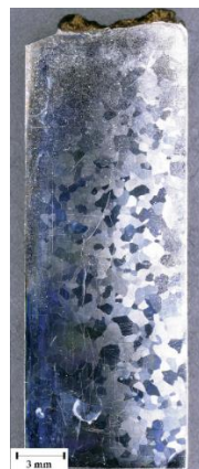
Figure 3.10 - Image à la loupe binoculaire d'une éprouvette attaquée de résilience du bloc LTIM- \omega
