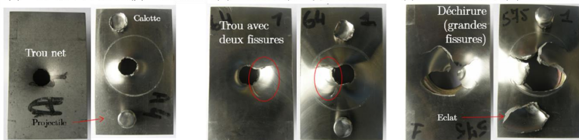
Figure 2.18 - Tôles d'épaisseur 1,9 mm d'un alliage (a)Ti-8,5Cr-1,5Sn ; (b) TA6V ; (c) Ti-5Al-7,5V après essai balistique à 406, 416 et 414 m.s -1 respectivement - d'après [Bro17]
