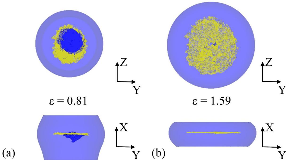
Figure 3-16 Evolution défaut échantillon M43 (a) course de déplacement 4.4 mm (déformation au centre  $\varepsilon = 0.81$ ), (b) course de déplacement 7 mm ( $\varepsilon = 1.59$ )
