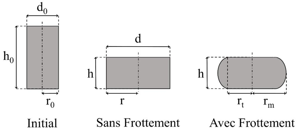
Figure 2-3 Eprouvette de compression avant et après déformation avec ou non prise en compte du frottement
