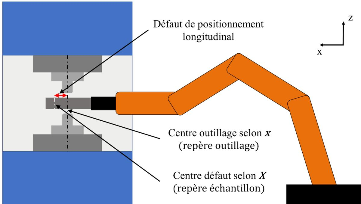
Figure 4-5 Représentation schématique du positionnement de l'échantillon
