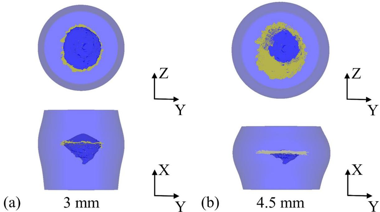
Figure 4-15 Evolution de la zone d'auto-contact du défaut contenu dans l'échantillon M43 en simulation après (a) 3 mm de course de compression et (b) 4.5 mm de course de compression
