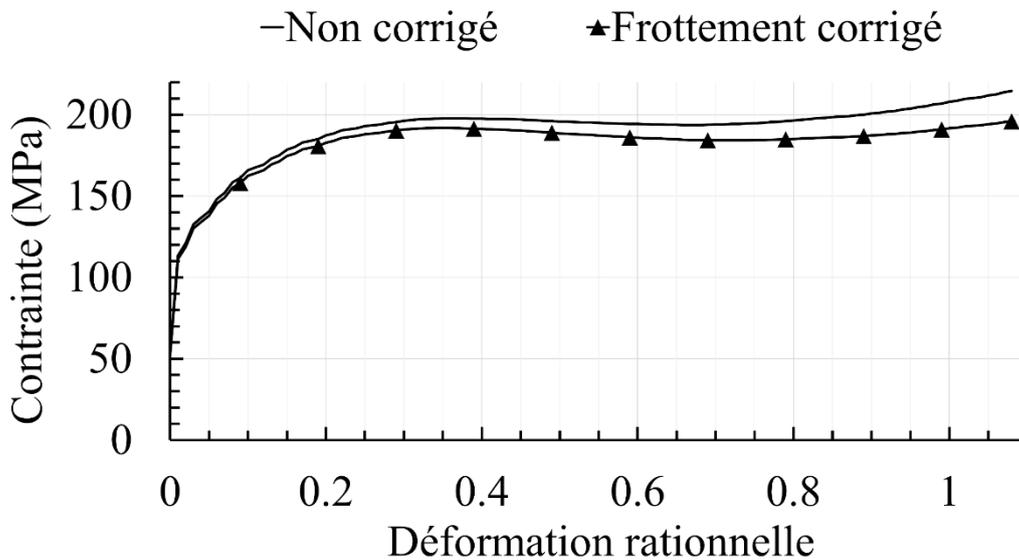
Figure 2-6 Impact de la correction du frottement (950 °C 20 s<sup>-1</sup>)
