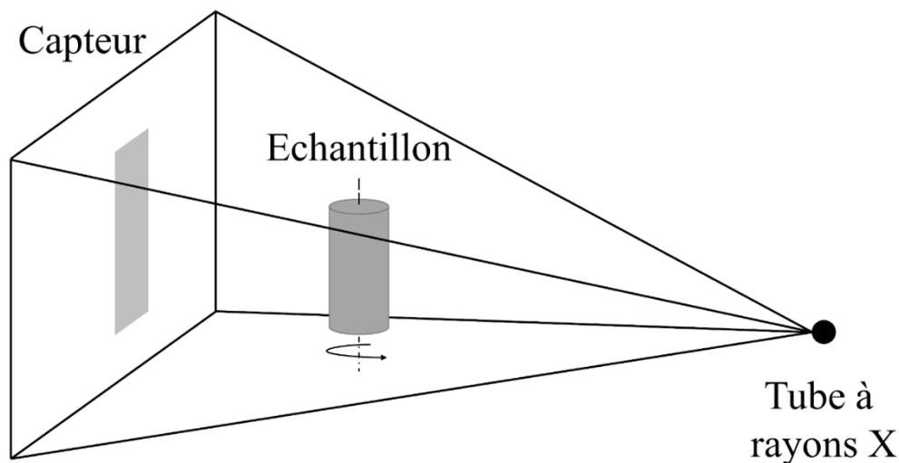
Figure 1-4 Tomographie avec tube à rayons X
