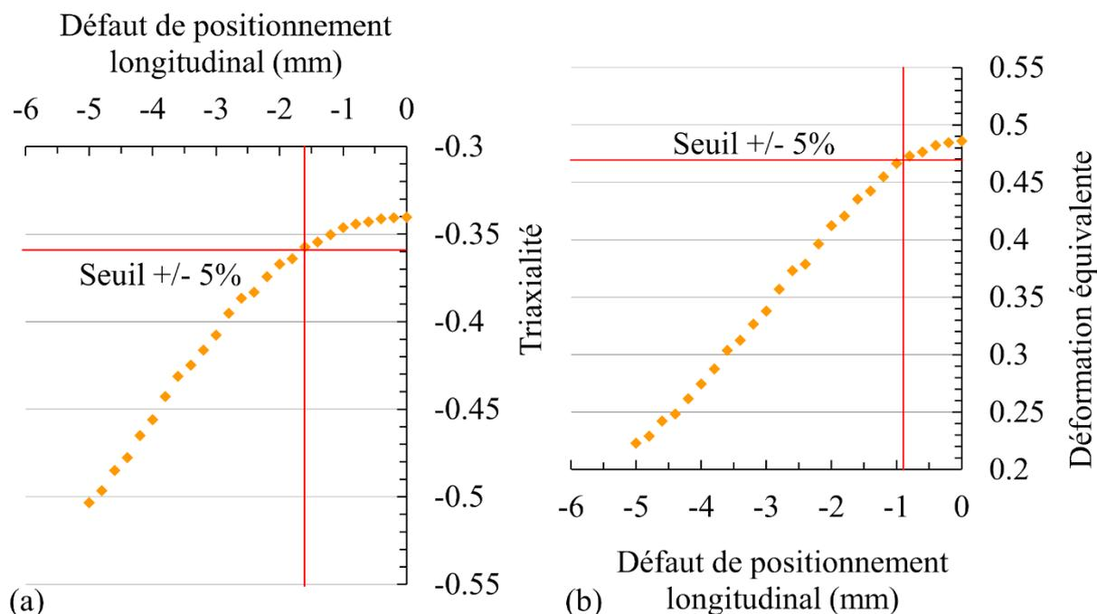
Figure 4-6 (a) Influence du décalage longitudinal sur le champ de triaxialité et (b) sur le champ de déformation équivalente au centre de l'échantillon
