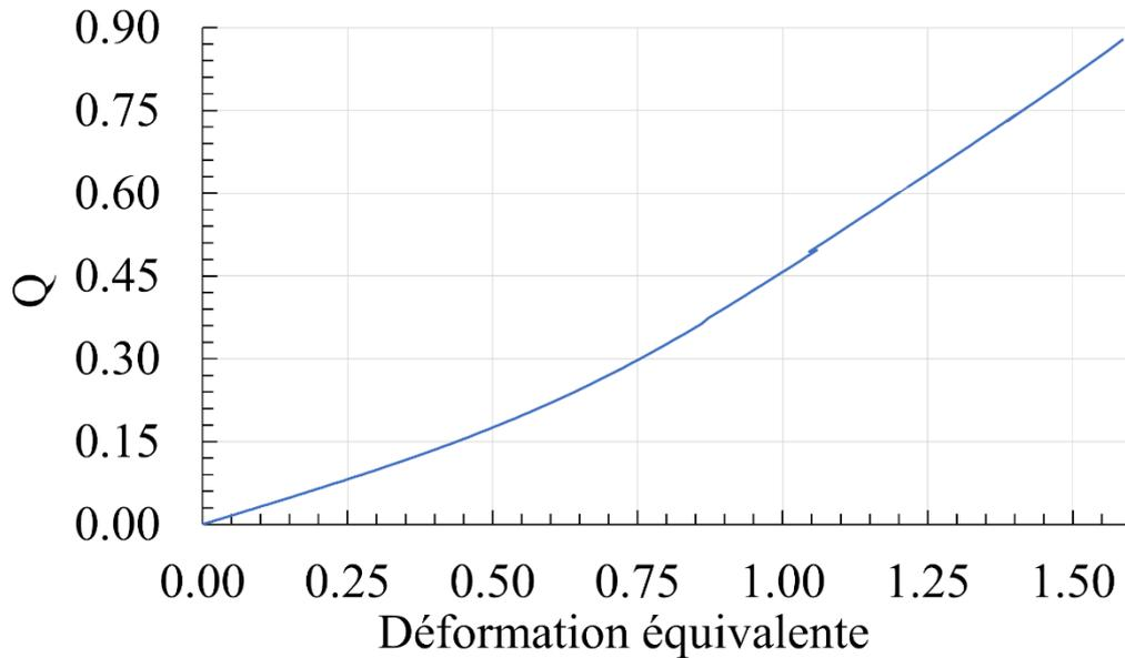
Figure 3-34 Essai de compression, intégration hydrostatique  $Q$  en fonction de la déformation équivalente au centre de l'échantillon ( $1200\text{ }^{\circ}\text{C}$ ,  $20\text{ s}^{-1}$ )
