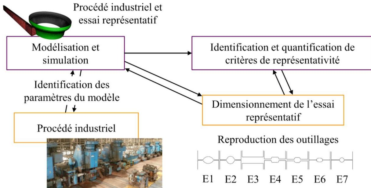
Figure 1-8 Etapes de développement de l'essai représentatif
