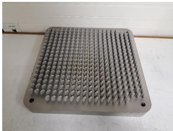
Figure 2.3 : Plateau de fabrication des éprouvettes (plateau de dimension 280 mm X 280 mm).
