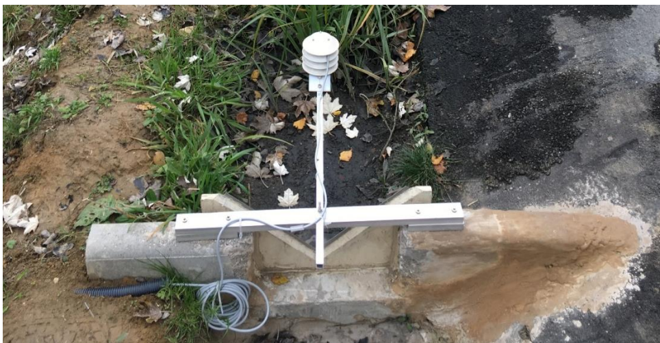
Figure 2.20. Déversoir triangulaire avec une sonde de mesure de la hauteur d'eau en surface de la noue filtrante.
