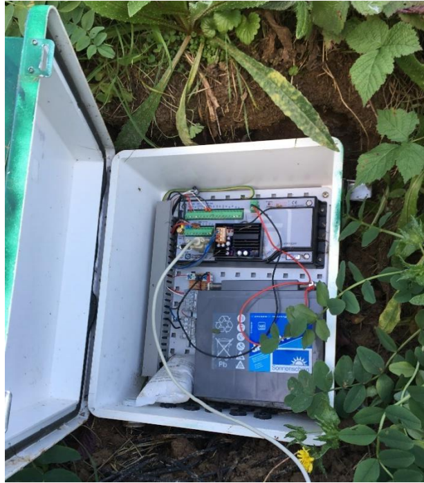
Figure 2.22. Centrale d'acquisition de données.
