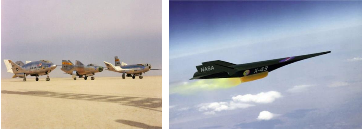
Fig. 27 A gauche le X-24A, M2-F3, HL-10 et à droite le X-43a Scramjet hypersonique sont des prototypes de corps portants.
