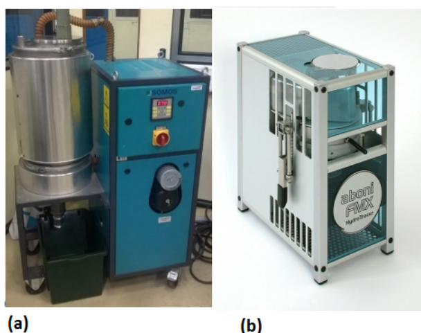
FIGURE 5.1. (a) SOMOS et (b) Hydrotracer Aboni FMX utilisés pour l'opération de séchage et de contrôle d'humidité résiduelle des granulés.
