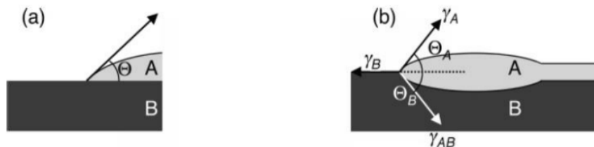
FIGURE 2.4. Diagramme schématique illustrant la définition de l'angle de contact sur un (a) substrat solide ou (b) liquide déformable (extrait de Geoghegan and Krausch [30]).
