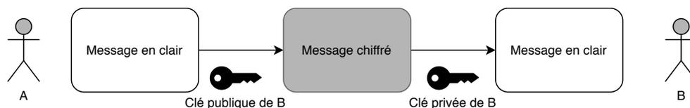
FIGURE 4.5 – Principe de la cryptographie asymétrique
