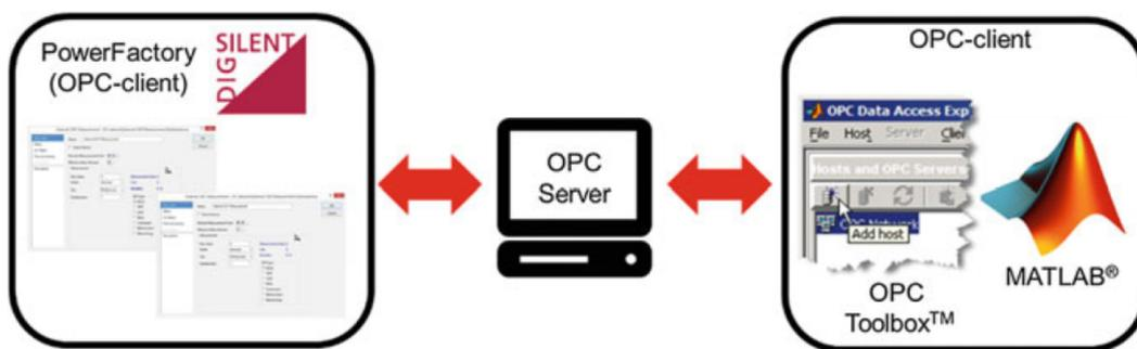
FIGURE 3.2 – Connexion OPC avec PowerFactory
