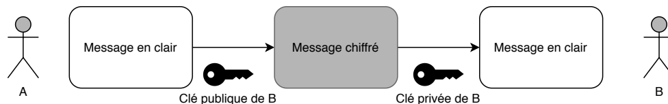
FIGURE 4.5 – Principe de la cryptographie asymétrique
