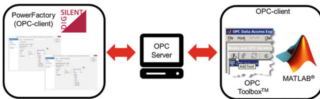
FIGURE 3.2 – Connexion OPC avec PowerFactory
