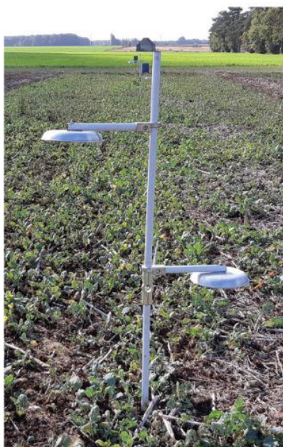
A. Mesure de volatilisation d'ammoniac : Mâts supportant les capteurs passifs
