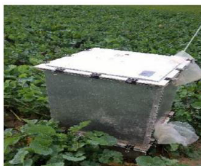
B. Mesure d'émission de N 2 O : Chambres statiques
