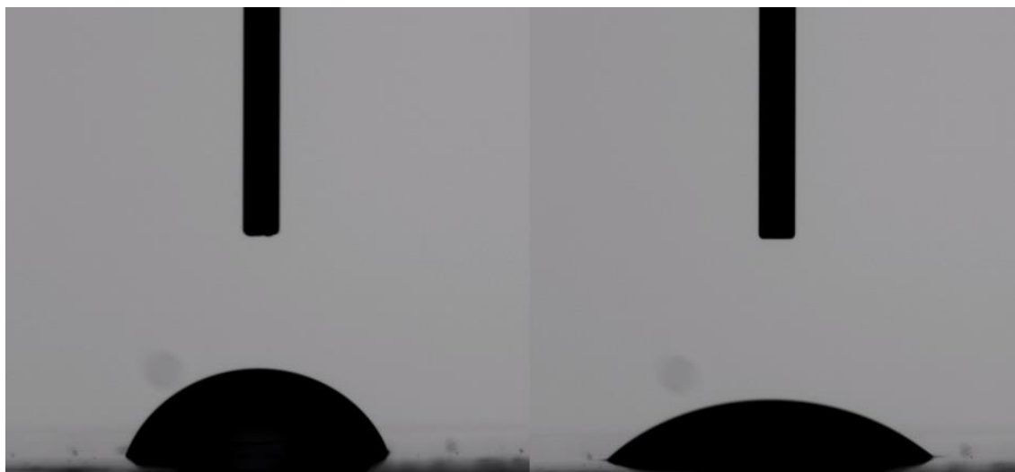
Figure 13 : Etalement d'une goutte d'eau sur un film de caoutchouc NRL : visualisation au temps initial (à gauche) et 45 secondes plus tard (à droite)
