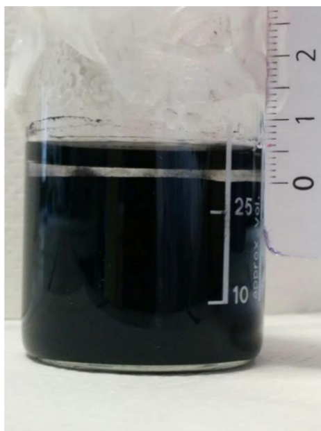
Figure 9 : Mise en évidence de la sédimentation après trois semaines de repos
