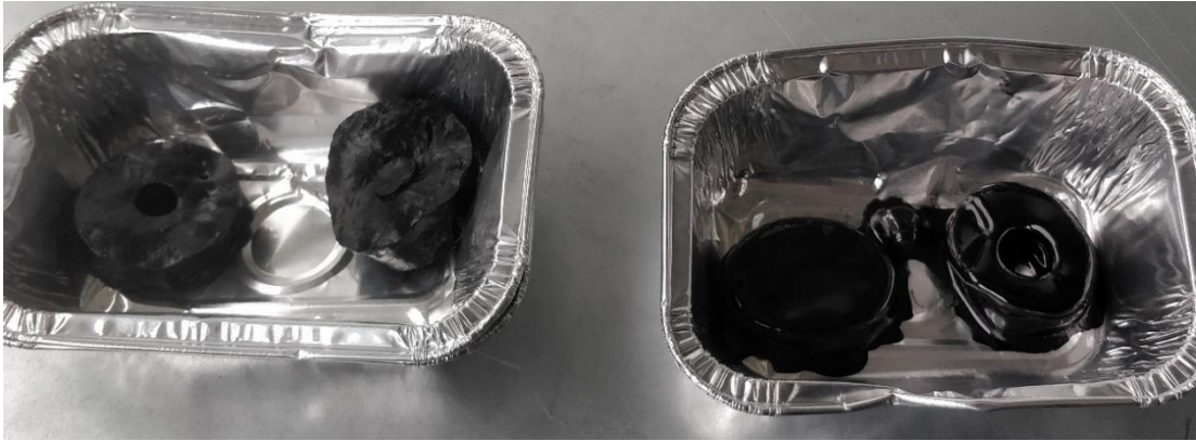
Figure 8 : Comparaison de l'effet de l'environnement sur le vieillissement du caoutchouc naturel. Le matériau de gauche a vieilli 24 h sous vide à 120°C ; celui de droite a vieilli sous air pendant 24 h sous air à 120°C. La couleur noir est due à l'ajout d'antioxydant
