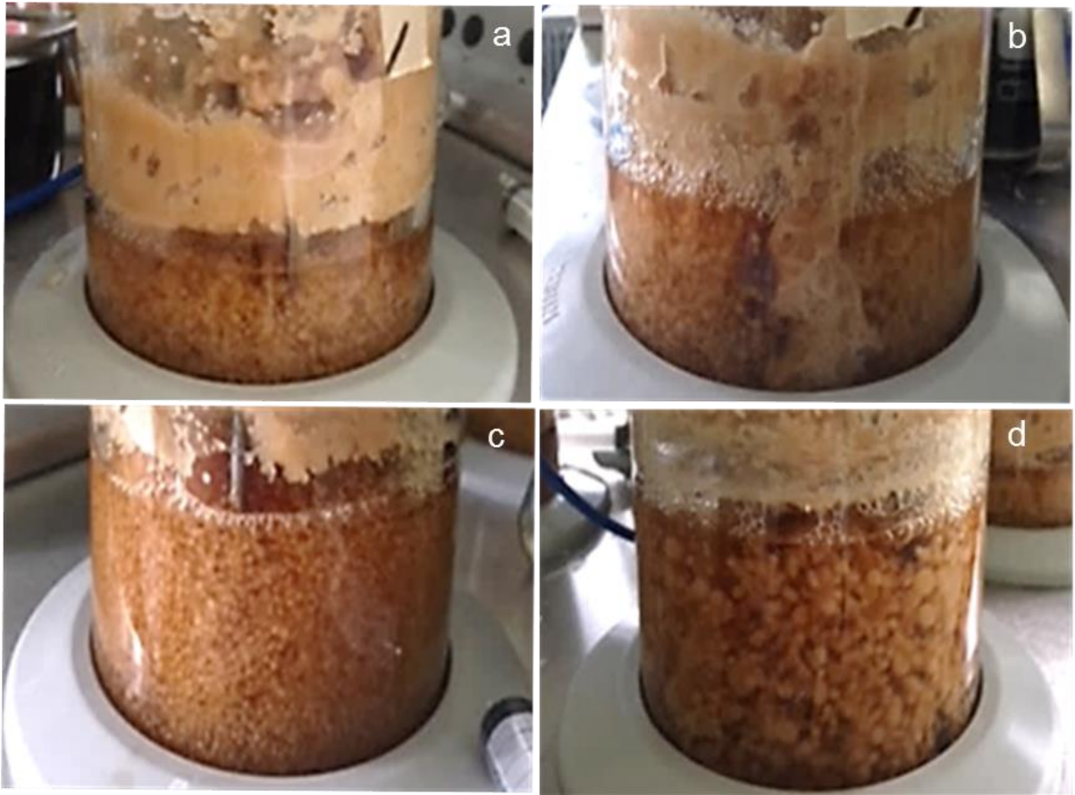
Figure 53 : Propagation A. oryzae par pré-culture EGM en bioréacteur DASGIP
