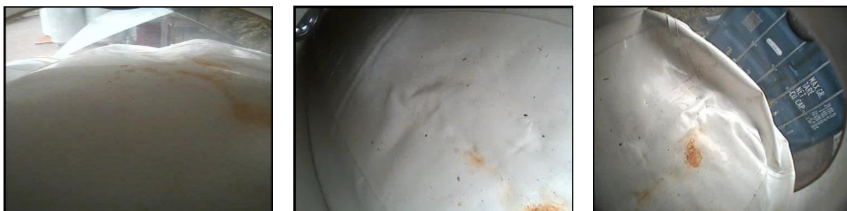
Figure 5: Etat de la vessie après 800 cycles
