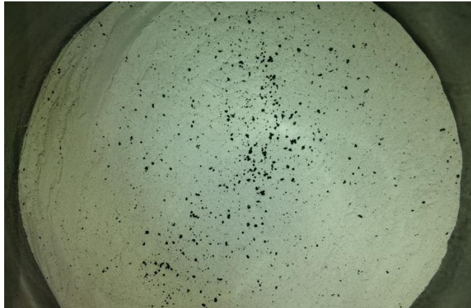
Figure II-41 : Photographie du mélange HA CIS + Carbone
