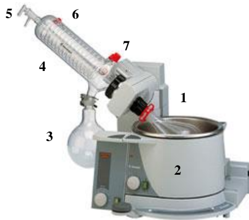
Figure II-38 : Schéma du procédé d'évaporation rotative du solvant
