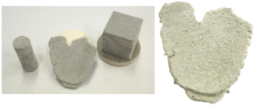
Figure IV-12 : Trois géométries de pièces fabriquées par SLM (cylindre, surface courbe, cube)
