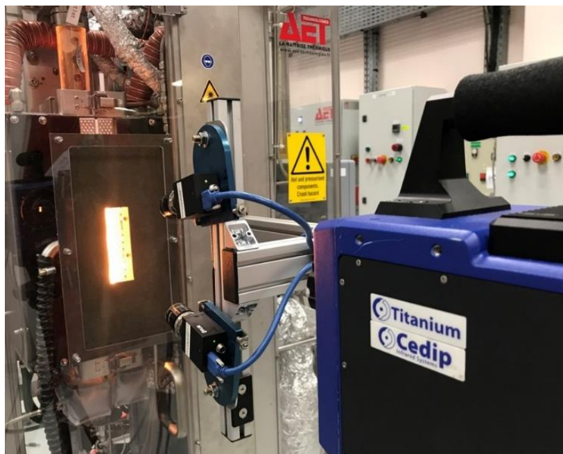
Figure II.1.18 – Montage expérimental avec ajout de la caméra thermographique
