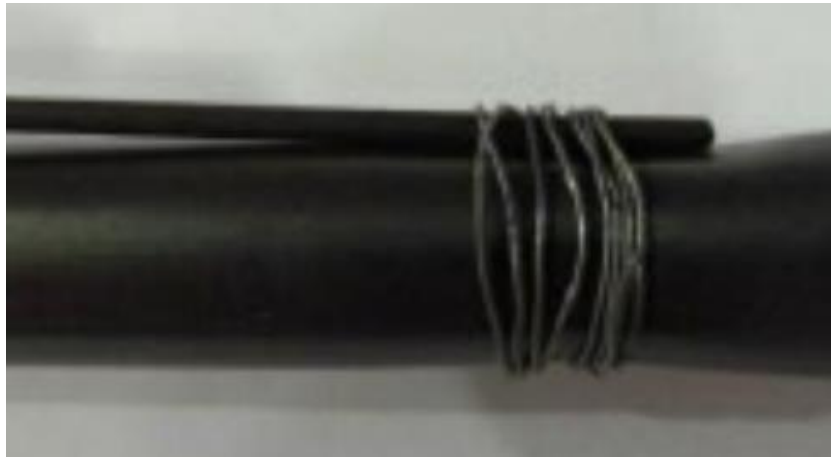
Figure II.1.5 – Fixation du thermocouple par ligature d'un fil de platine à +50mm du plan milieu
